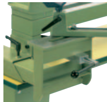
Le dispositif de tournage extérieur permet de tourner des pièces jusqu' à 750 mm de diamètre, en porte-à-faux de 300 mm
