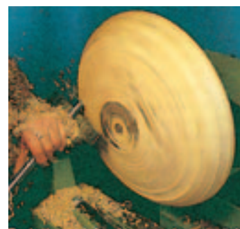
Tournage d'une coupe avec poupée pivotée 90° et utilisation du dispositif de tournage extérieur
